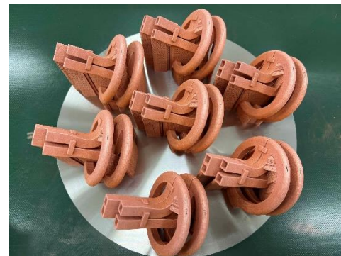
3Dプリンターで製作した誘導加熱コイルの一例
