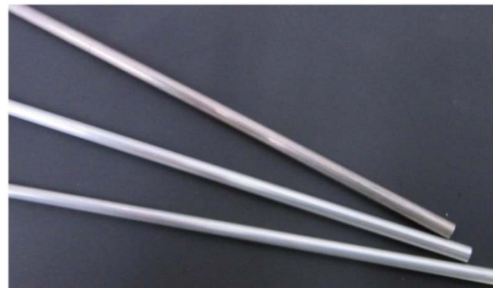
医療用ステントに適用可能な高精度長尺マグネシウム細管
