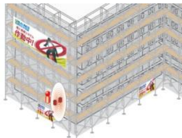
仮設足場侵入警報システム
