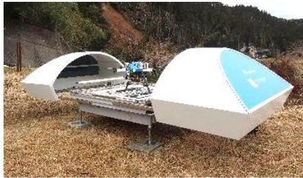
ドローンポートから自動かつ定期的に発着するドローンにより、地震の影響で河川に出来た土砂ダムを継続的に監視
