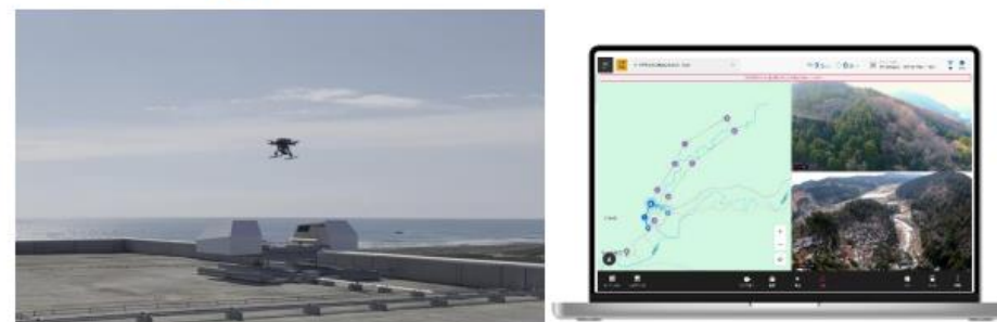
ドローンポートシステムから自動離着陸するドローン(左)とリアルタイム監視が可能なユーザーインターフェース(右)
