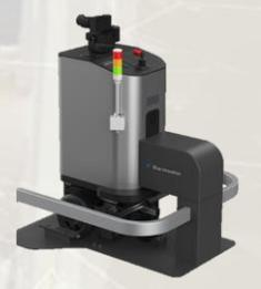
新規開発された充電ポートが付属。4時間の充電で4時間の巡回点検が可能です。巡回点検後、充電ポートに自動で戻るため、現場に行く手間を減らします。
