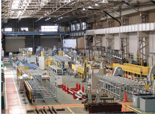
✓ 丸ステンレス鋼管 下関工場 BA管製造設備増強
