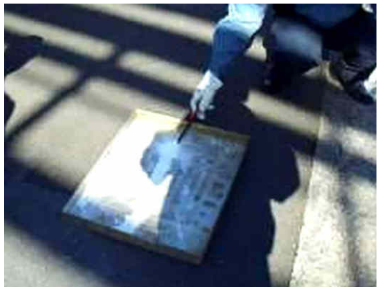
図 68 樹脂粉への着火テストの様子
