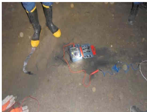
図 49 1階床と接地極の間の抵抗測定の様況
