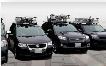
※MMSとは、三菱電機が開発した移動式高精度3次元計測システム「モービルマッピングシステム」です。
