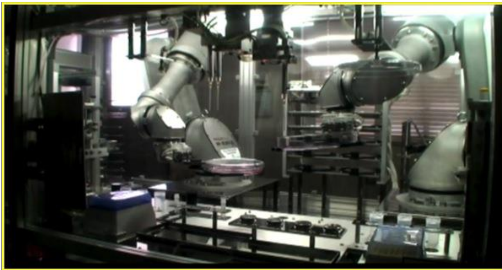
▲澁谷工業の製造する自動培養化装置（培養を自動化）
