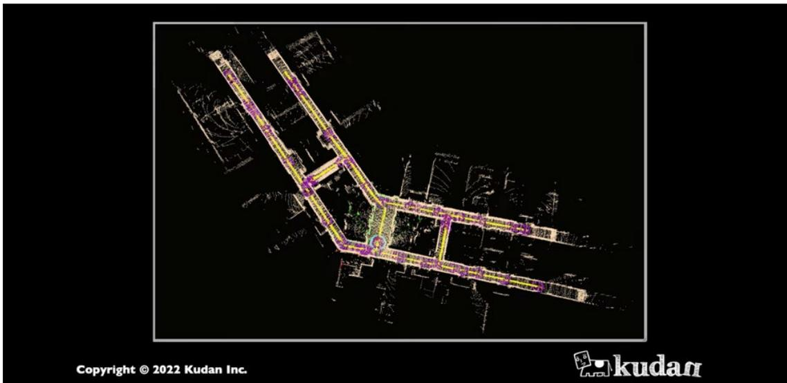
図 3 : Kudan 3D-Lidar SLAM
