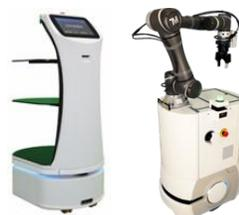
マップデータを元に走行を行い、マニピュレータが人の代わりに作業を行います。ロボットシステムインテグレーターだけでなく、自社オリジナル搬送ロボットも開発。
