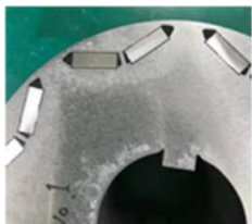
モーター磁石固定用封止材
