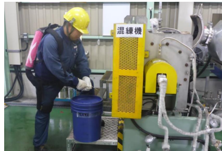
改善イメージ：パワースーツによる作業負荷軽減（検証中）
