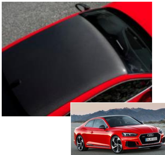
三菱ケミカルのCFRPが採用された 「Audi RS 5 Coupe」のルーフ (オプション仕様) ※画像提供：Audi社
