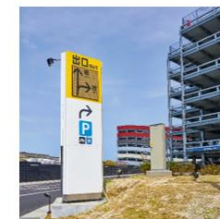
可変式誘導画面が表示されるLEDサイネージ
