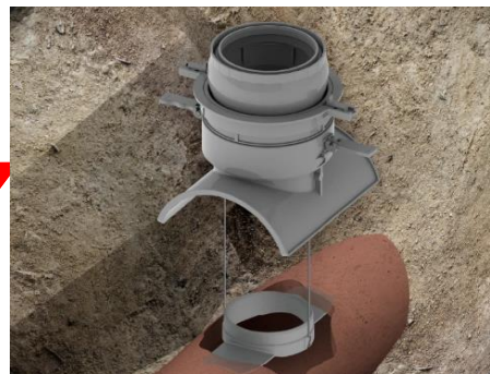
漏水個所に接合し補修
