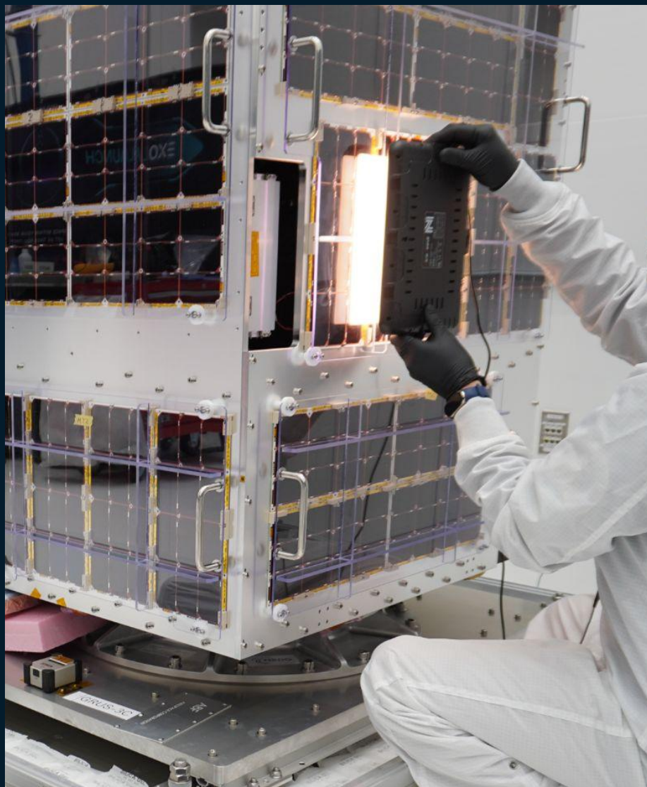
「GRUS-3」での太陽光パネルの健全性試験
