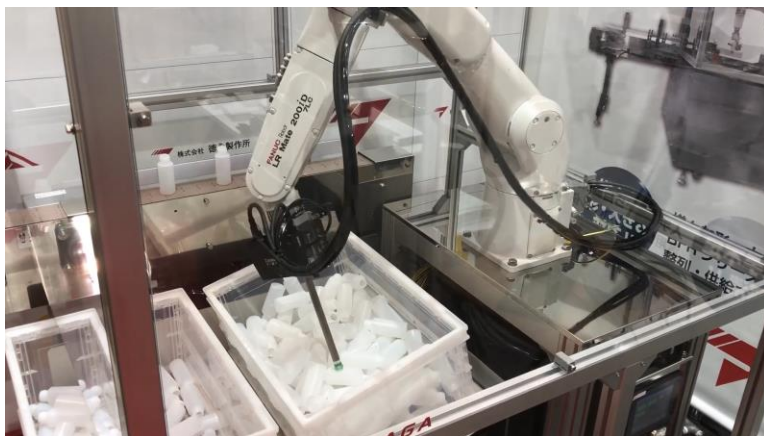
バラ積み状態の（半）透明ボトルを認識、バキュームピッキング
