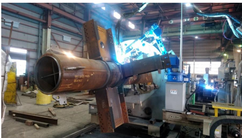
【柱溶接ロボット】
