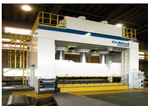
（清鋼材）工場内観（800t油圧プレス機）
