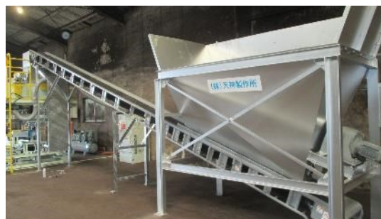
TM供給ホッパー 堆肥の製品化・ペレット化に使用され、工場の粉体投入などでも使用される設備。
