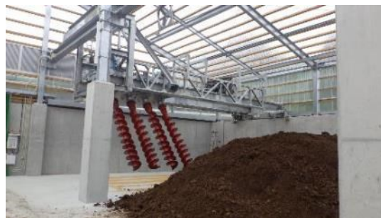
TM片懸垂式発酵攪拌機 10～18m幅×100mの堆肥舎を堆肥高約3mにて堆肥化处理可能な機械設備。
