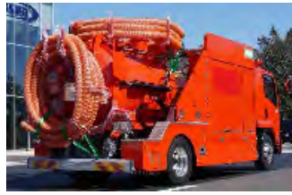
兼松エンジニアリング社 土砂吸引車
