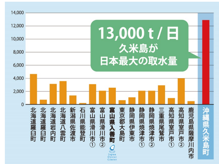
各海洋深層水取水施設における取水量比較
