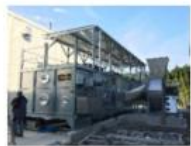
木質チップ用低温 水型ベルトドライヤー
