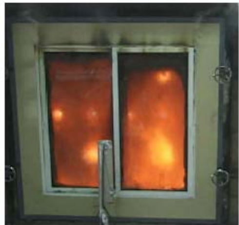
非加熱側の試験体の状況
