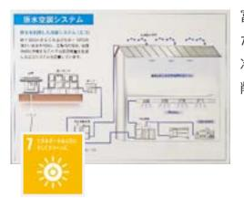
富士吉田工場では、地下水200mからくみ上げた9度~10度の冷たい原水を利用し、工場内の冷房・設備冷却に活用することで電気使用料を削減したエコシステムを設置しています。
