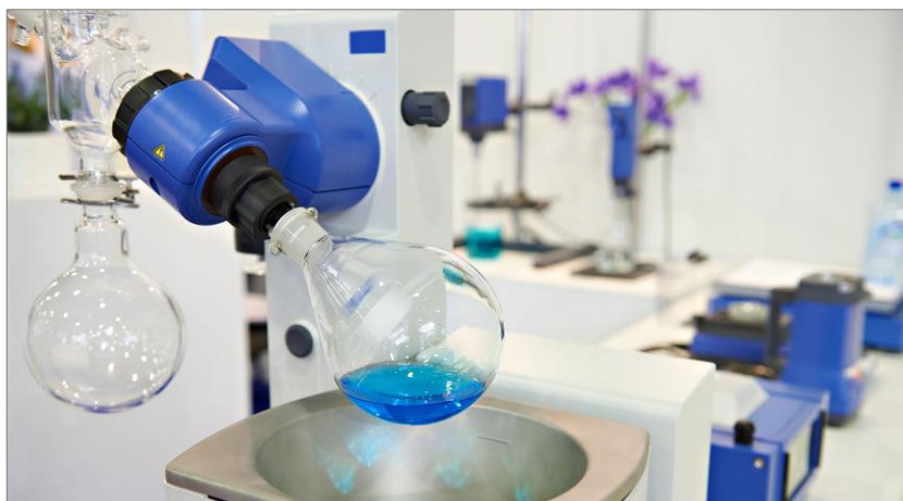
エバポレーターによる試薬濃縮
