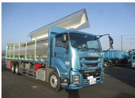
写真：荷台が大きく開く他、全ての操作を運転席で行える特注の灰処理対象物運搬車両（双葉町仮設処理第一施設で稼働中）
