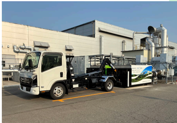
▲TDK(株)様 本荘工場西サイトにて低温排熱を回収する様子
