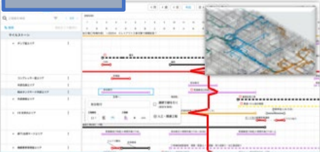
BIMモデルと紐づけた工程作成 施工記録との連携による進捗状況の可視化
