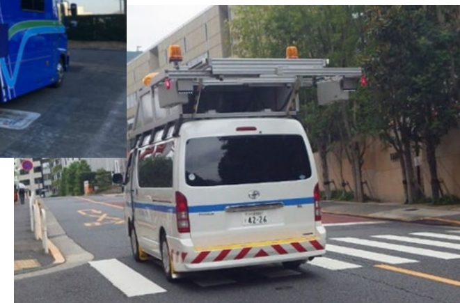
移動式たわみ測定装置 MW DPlus
