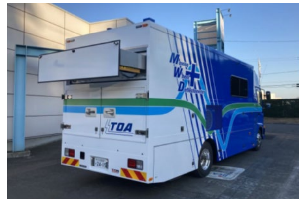
移動式たわみ測定装置 MW DPlus
