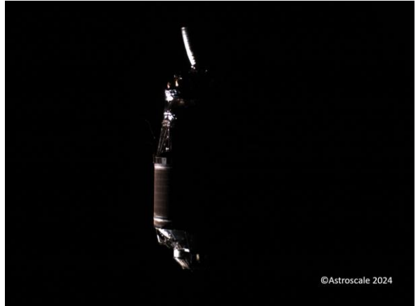
観測対象デブリの定点観測によるタイムラプス動画 (2024年5月、デブリの後方約50mの距離から撮影)
