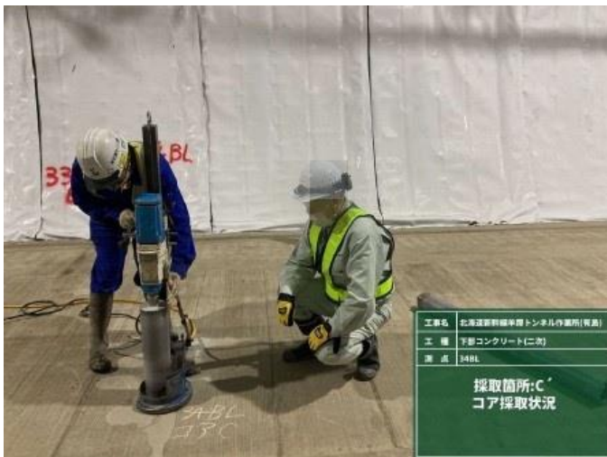
コア採取による圧縮強度/静弾性係数試験
