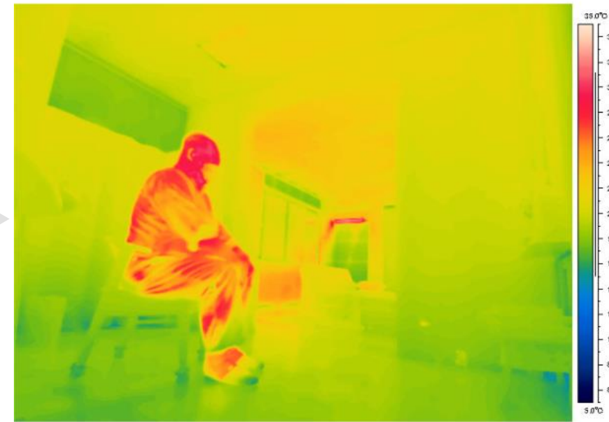
断熱+気密改修後
