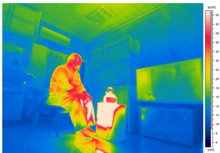
断熱+気密改修前
