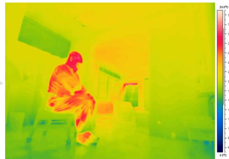
断熱+気密改修後
